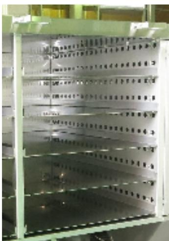
整流板 (段差補正用ダンパ)
